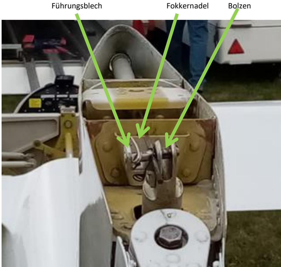
**FALSCH ! Die Fokkernadel steckt links vom Führungsblech. Der Bolzen ist UNGESICHERT und stellt KEINE SICHERE VERBINDUNG ZUM HÖHENRUDER dar.**
