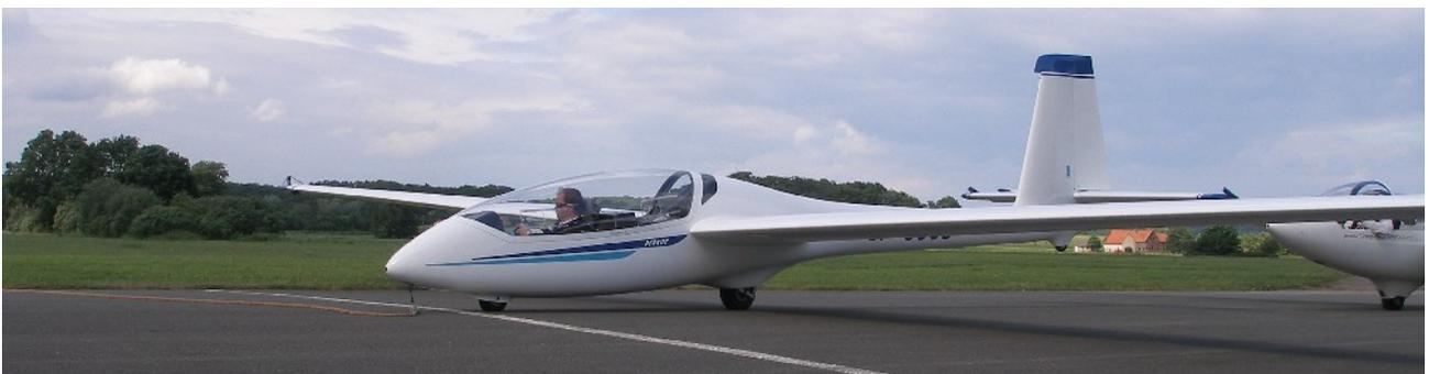
Trotz der sehr weichen Flügel des Prototypen lässt sich das Flugzeug präzise steuern. Hier wird in der Serie noch nachgearbeitet, die Tragflächen sollen steifer werden. Ein Strömungsabriss kündigt sich gut durch den nachlassenden Steuerdruck an. Schon nach kurzer Zeit kann man die Geschwindigkeit hervorragend über das Fahrtgeräusch einschätzen.
