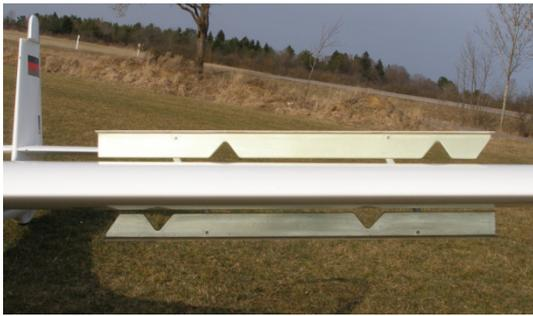
Leider müssen wir alle ja irgendwann wieder zurück an den Boden, dank der großen Bremsklappen auf Ober- und Unterseite ist die Steuerung des Anflugs kein Problem. Die Wirkung ist vergleichbar mit Discus oder K8b, die sprichwörtlichen Scheunentore. Auch Variationen in der Anfluggeschwindigkeit lassen sich mit den großen Klappen sehr gut ausgleichen, 100 km/h oder 140 km/h, beides bremsen die Klappen gelassen ab. Der Spielraum für den Piloten ist entsprechend groß.
